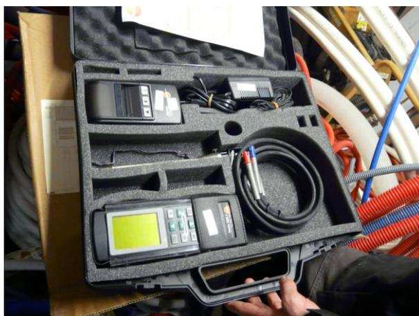
*Analyseur/test de combustion*
